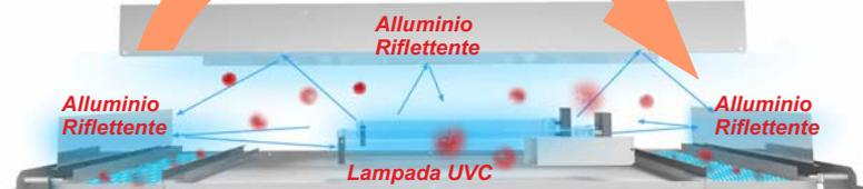
Uccide i batteri all'interno della cavità e sullo schermo del filtro mediante l'irradiazione della lampada UVC. (con alluminio riflettente all'interno della parete della cavità, l'intensità battericida degli UVC è aumentata al massimo).
